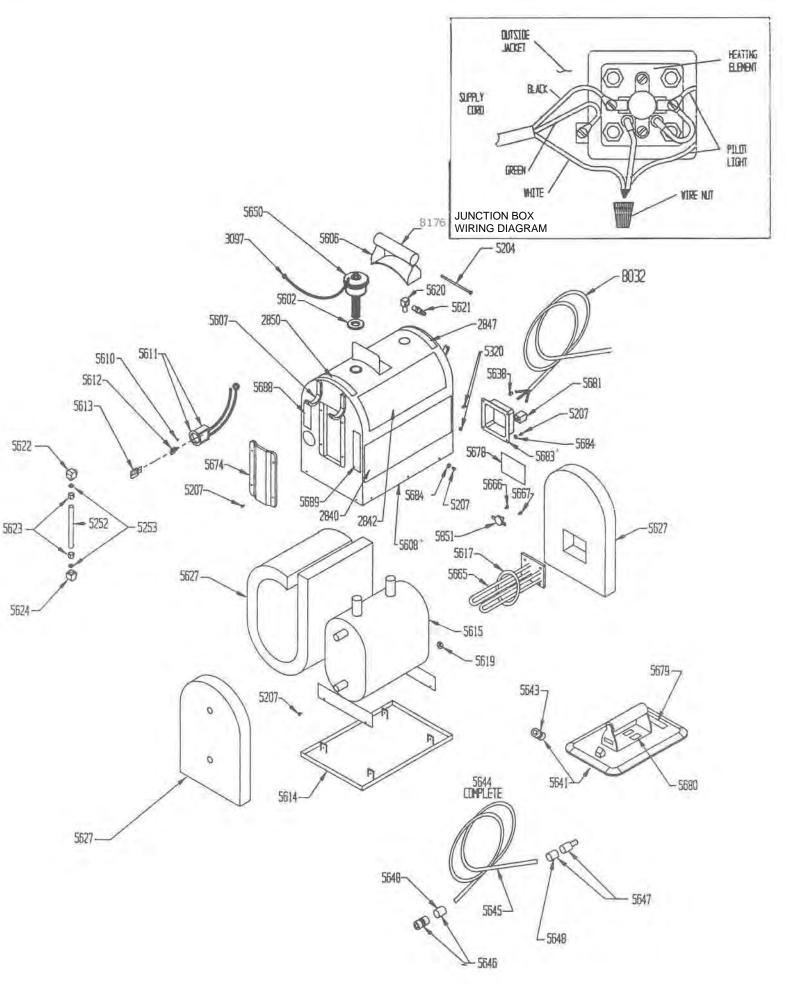
\*\*NOTE: AT LEAST 1 SCREW ON JUNCTION BOX COVER (#5683) & 1 ON JACKET (#5608) MUST CONTAIN PAINT CUTTING WASHER FOR PROPER GROUNDING\*\*
